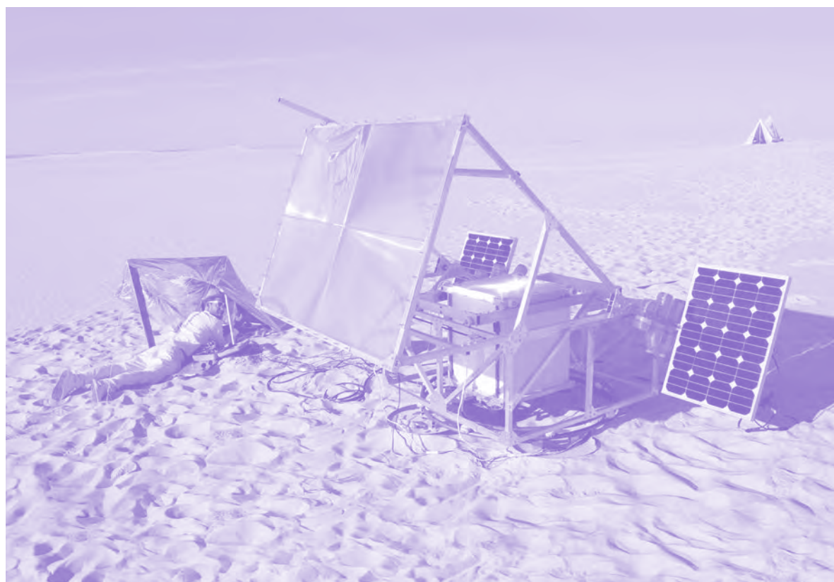
98 Solar Sinter, solarbetriebener 3D-Drucker von Markus Kayser, 2011
